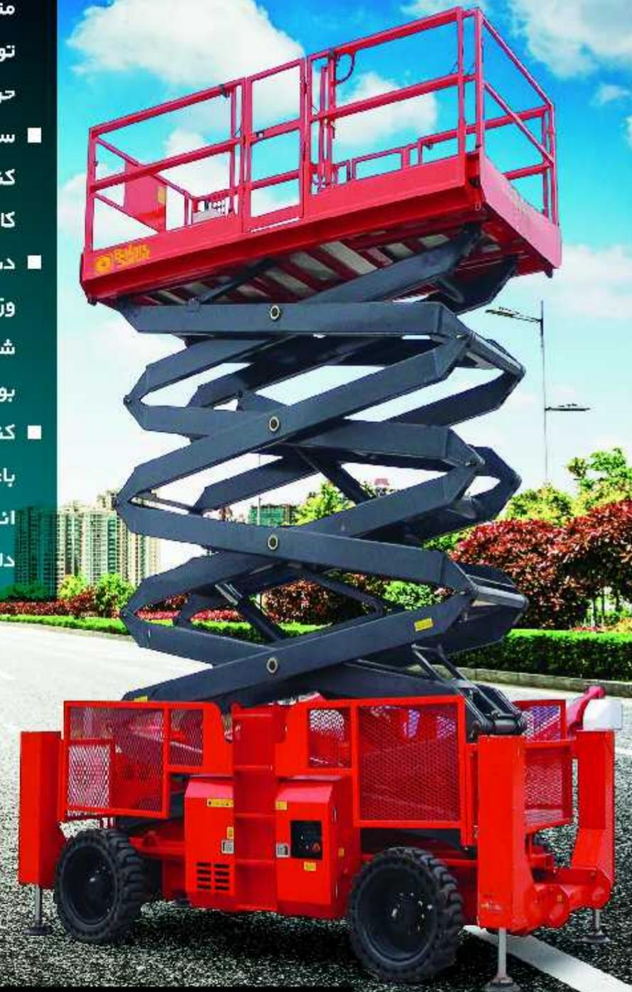
در هنگام کار روی سطوح شیب‌دار و لغزنده باید از بالابرهای مجهز به جک پایدار کننده استفاده نمود. ضمن این‌که زمین باید دارای مقاومت کافی برای تحمل وزن بالابر و یا استقرار جک‌های پایدار کننده را داشته باشد. در مواردی که زمین نرم و نفوذ پذیر است باید از پدهای مخصوص زیر جک‌های پایدار کننده استفاده کرد تا با افزایش سطح و کاهش فشار استحکام زمین افزایش می‌یابد.
