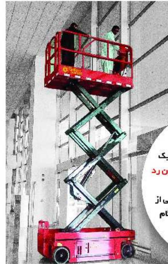
در مواردی که بالابر روی سطوح حساس یا سیقلی مانند سنگ، سرامیک و مرمر کار می کند باید از چرخ های بدون رد (NON-MARKING) استفاده کرد. این چرخ ها از نوع خاصی از لاستیک ساخته شده اند که در هنگام حرکت اثر سیاهی از خود باقی نمی گذارند
