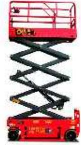
■ بالابر سیزری با موتور الکتریکی و با بالاترین کیفیت در سیستم هیدرولیک (Hydroforce)، سیستم برق (Deltatech) و همچنین باتریهای Trojan آمریکایی، دارای ظاهری زیبا و کاربردی آسان می باشد که با قابلیت خودکششی و هدایت ساده در محیطهای داخل و خارج از ساختمان قابل استفاده است
