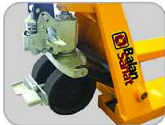
موقعیت ترمز در جک پالت با سامانه ترمز پایی
