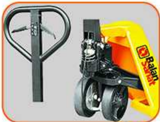
موقعیت ترمز در جک پالت با سامانه ترمز دستی
